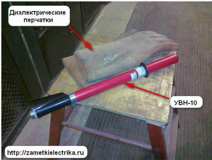
В качестве основного электрозащитного средства оперативный персонал применяет указатель высокого напряжения УВН-10, у которого имеется штамп о пройденном испытании.
